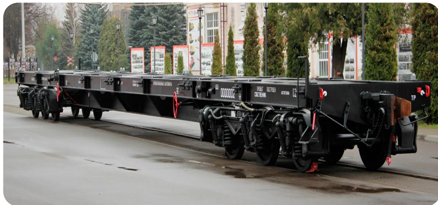
Вагон-платформа для перевозки контейнерных грузов на скорости до 140 км/ч
