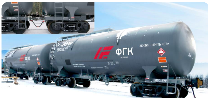
Вагон-цистерна восьмиосный (двухсекционный полужесткий сцеп) для перевозки нефтепродуктов
