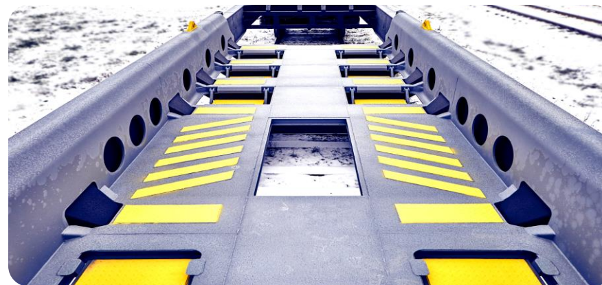
Контрейлерная платформа «колодезного» типа для перевозки полуприцепов и контейнеров
